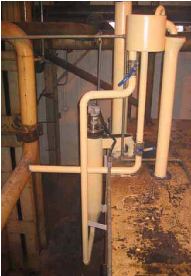
Figura 2.6 – Instalación para medición de Brix para miel
