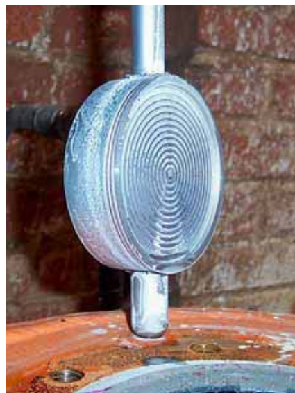
Figura 2.3 – Proceso sin incrustación de cal en los diafragmas del DT
