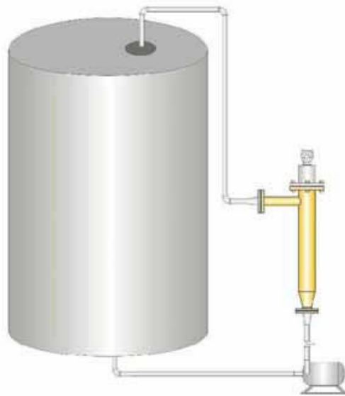
Figura 2.20 – Recirculación con bomba
