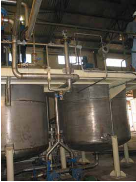
Figura 2.11 – Tanque de flujo dividido instalado después de la bomba de proceso
