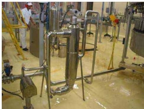
Figura 2.31 – DT Midiendo Brix en una Fábrica de Refresco
