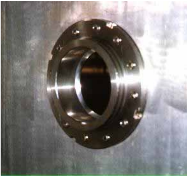
Figura 1.8 – Ejemplo del Montaje del Adaptador de Tanque (Visto del Lado Externo del Tanque)
