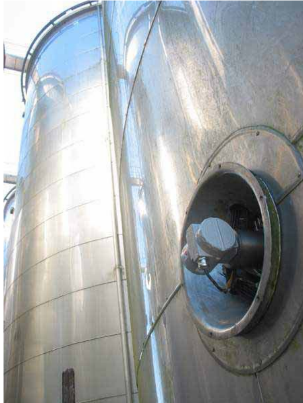
Figura 2.30 – Medición de Grado Plato en un Tanque
