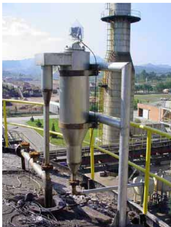
Figura 2.36 – Medición de Licor Negro (Flujo Ascendente)
