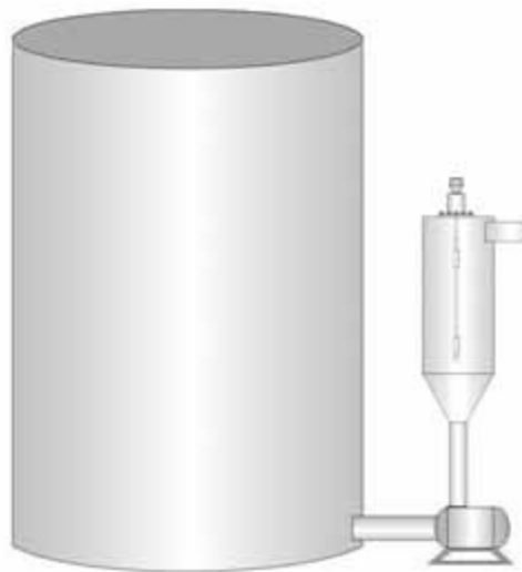
Figura 1.22 – Instalación con todo el flujo pasando por el DT (Flujo Ascendente)
