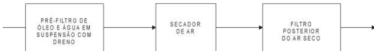
Figura 1.14 - Sistema de Condicionamento da Qualidade do Ar
