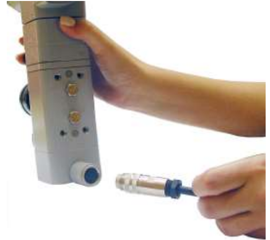
Figura 1.20 - Conectando o cabo ao Posicionador
