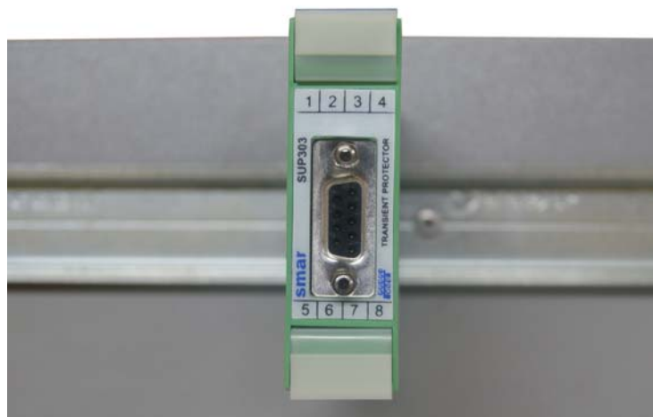
Figura 3 – SUP303 instalado em trilho DIN
