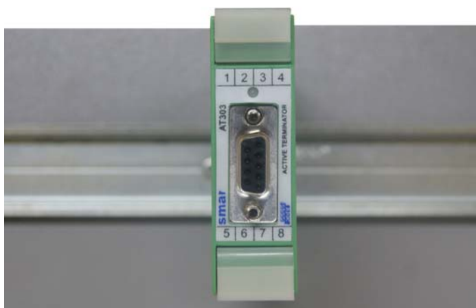
Figura 4 – AT303 instalado em trilho DIN
