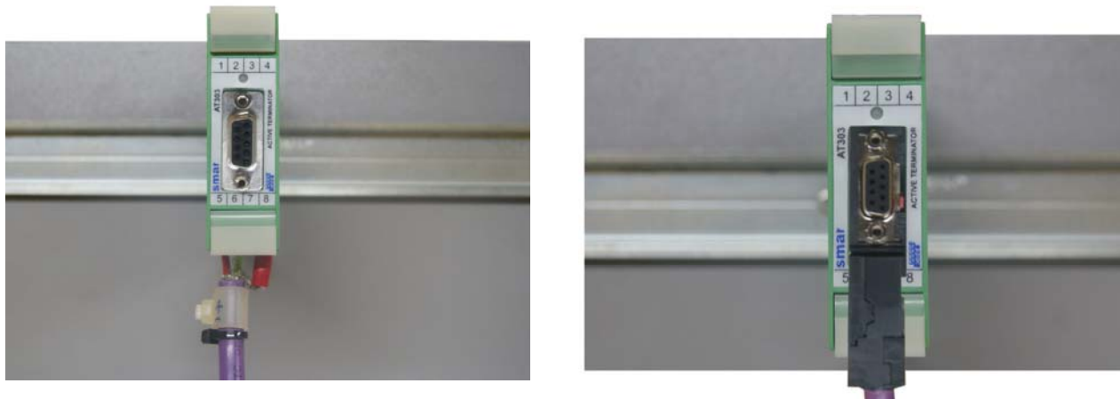
Figura 5 – AT303 instalado em trilho DIN – ligação direta e usando conector Profibus
